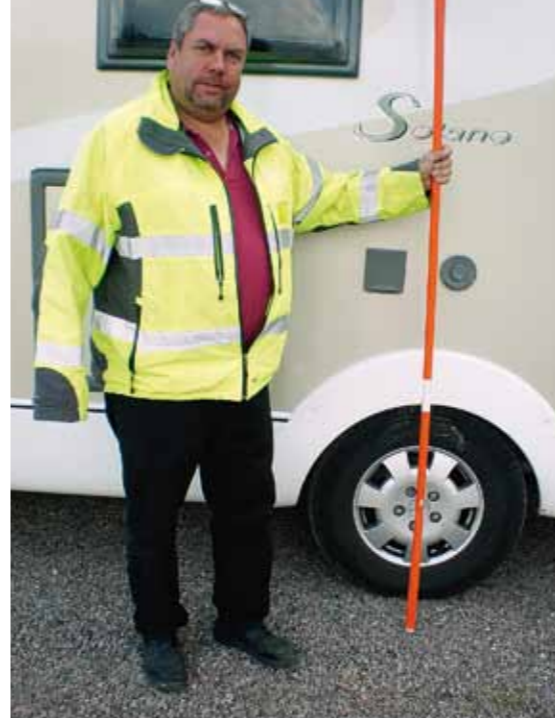
Leif Broberg, yrkesförare, visar bilens vridcentrum, mitt för de bakre hjulen.
