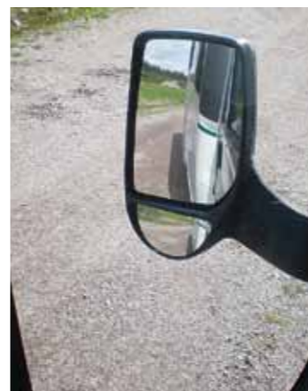
De båda backspeglarna är det viktigaste för en husbilsförare. De ska vara raka och visa hela sidorna på bilen.
